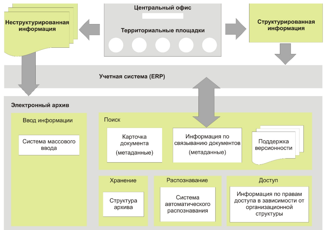
Рис. Электронный архив: Базовая архитектура решения
