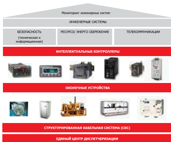
Рис.2. Интеллектуальная инженерная система: инженерные и программно-аппаратные компоненты для сбора информации
