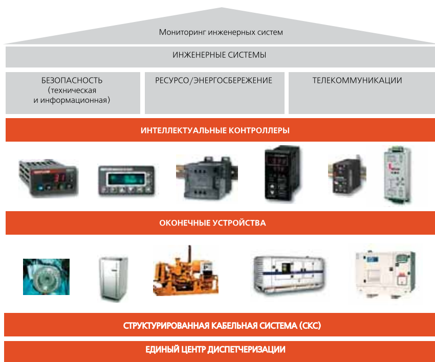
Рис. 4. Интеллектуальная инженерная система: инженерные и программно-аппаратные компоненты для сбора информации
